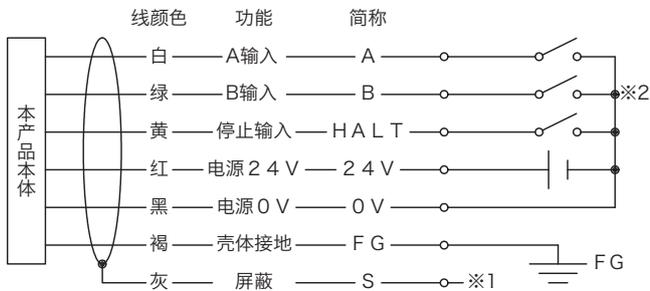
※1 使用屏蔽线时, 屏蔽线与 FG (地线) 或 0V 相连接。
