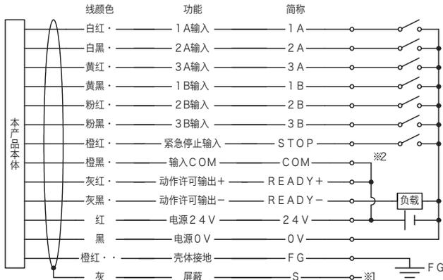
※1 使用屏蔽线时, 屏蔽线与 FG (地线) 或 0V 相连接。
