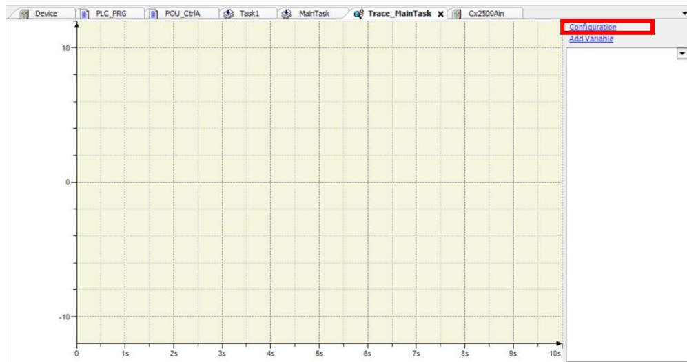
Figure 203 トレース画面 Configuration の選択
