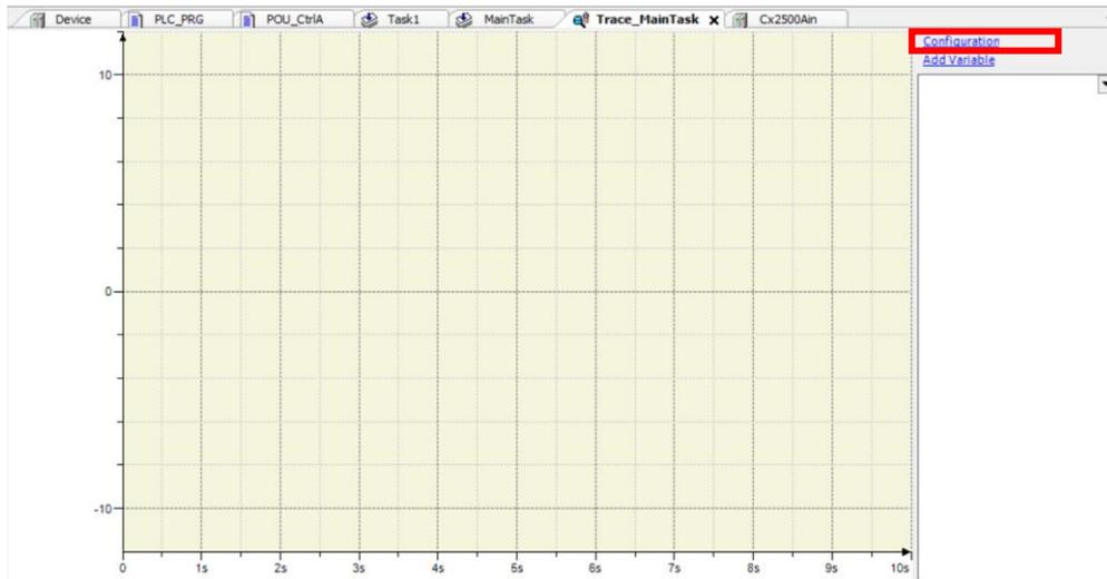
Figure 207 トレース画面 Configuration の選択
