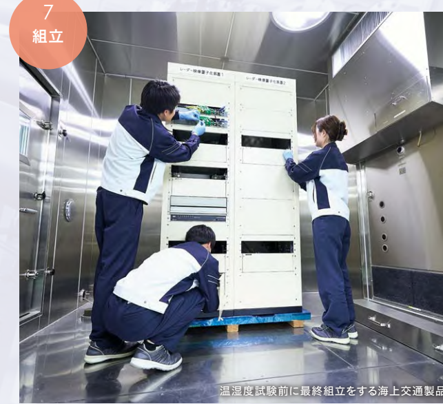
温湿度試験前に最終組立をする海上交通製品
