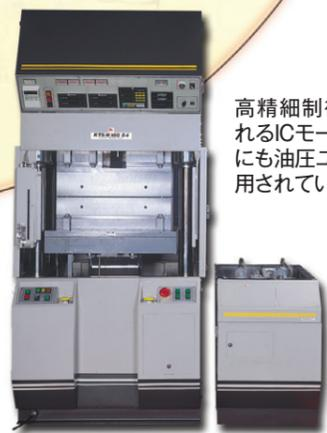
高精細制御が要求されるICモールドプレスにも油圧ユニットが採用されています。
