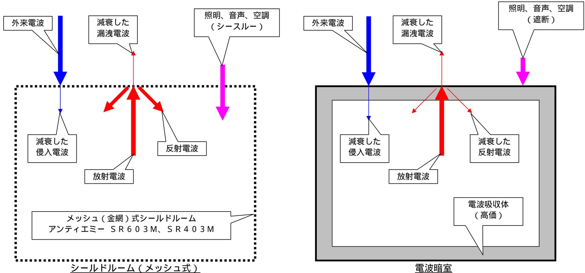
室外からの外来電波を遮断(減衰)し、室内の放射電波が室外に漏れるのを防ぐ(減衰させる)。
