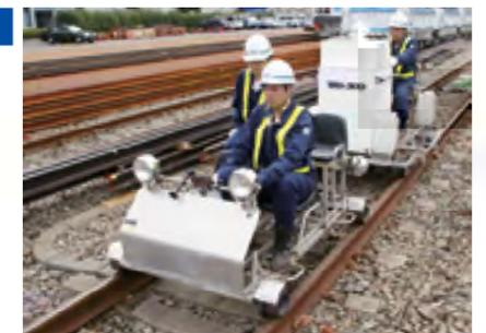
走行式レール探傷装置 (TRD-300型)
