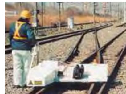
分岐器検査装置 (SPG-1N型)
