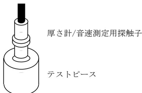
図 2.2.7-3 厚さ計/音速測定用探触子の校正
