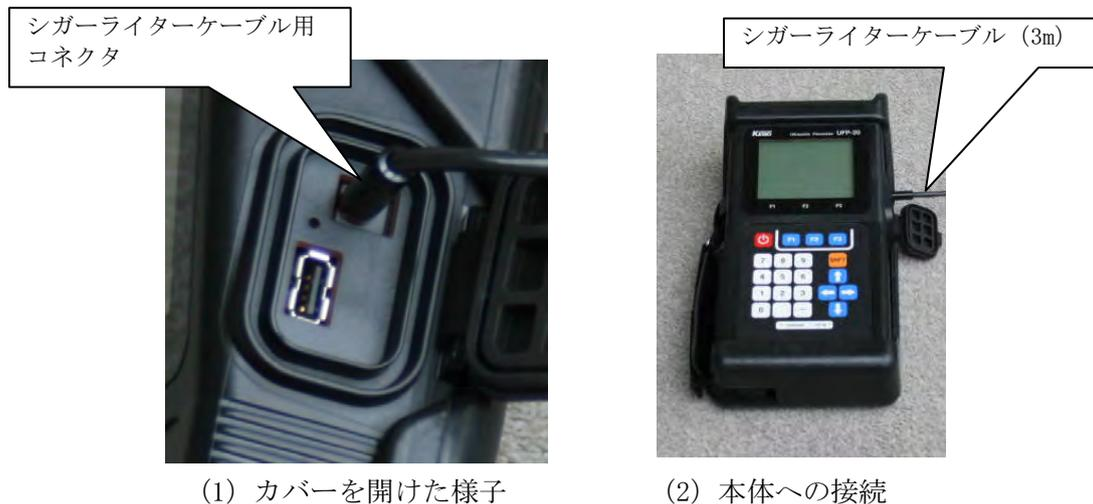
図 1. 2. 4-12 シガーライターケーブルの接続
