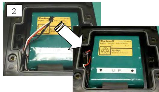
2. バッテリーケーブルをコネクタに接続します。断線に注意してください。
