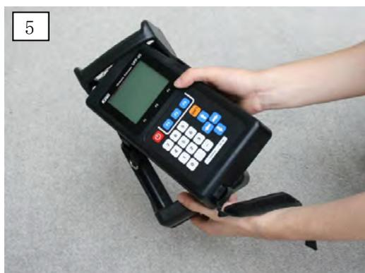
5. 保護カバー上部を外し、本体を保護カバーから取り出します。
