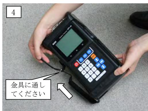
4. 保護カバー下部へ本体を挿入後、ハンドストラップを取り付けます。
