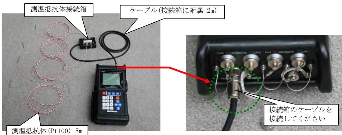
図 1. 2. 4-4 測温抵抗体の接続
