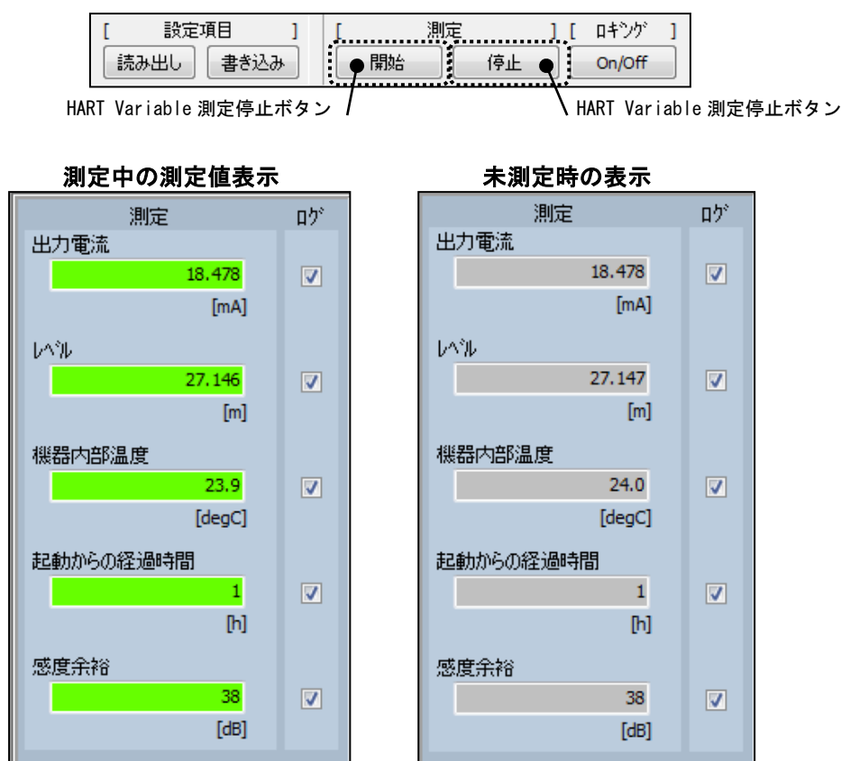
図 6. 9. 20 HART Variables の測定
