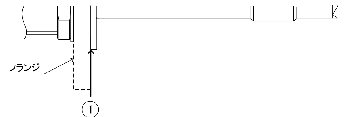
図 10. 1. 9 ロッドアンテナの計測基準面
