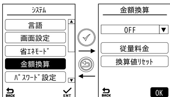
設定された「従量料金」にて算出し、「金額換算」ページに設定された単位を表示します。算出式は下記の通りです。
