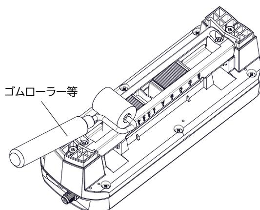
(注1) 低温(20℃以下)では両面テープが固くなり、接着強度が低下します。上記作業は20℃以上の環境で行ってください。
