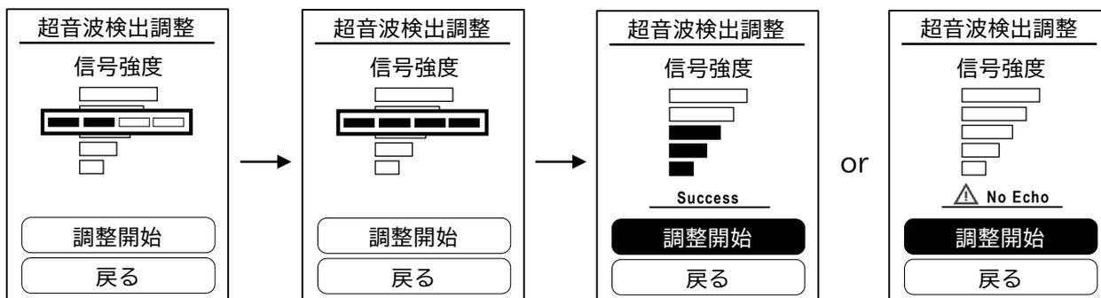
調整後の5段階バーレベルについて、目安は下表の通りです。バーレベルが1でも計測はできますが、取付け箇所をずらす等再調整を実施し、感度が良い点で計測することを推奨します。
