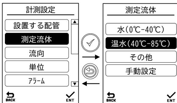
(注) 水温が常に 40°C 以上となる配管では、温水(40°C-85°C)設定を推奨します。
