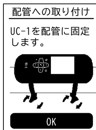
(注1) バンドが破損しないよう締め付け過ぎにご注意ください。
