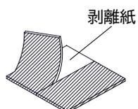
d) カプラントシートをセンサ底面に貼り付けた後、ゴムローラー等を用いてシートを圧着してください。
