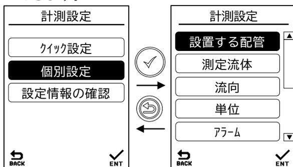
「個別設定」から、「設置する配管」または、「測定流体」を変更した後、メニューから「計測値」を選択したときに、再計算した「センサ位置合わせ」を表示します。センサ位置を変更し取付け直してください。次に「超音波検出調整」を表示しますので、「開始」を押下し再調整を実施してください。
