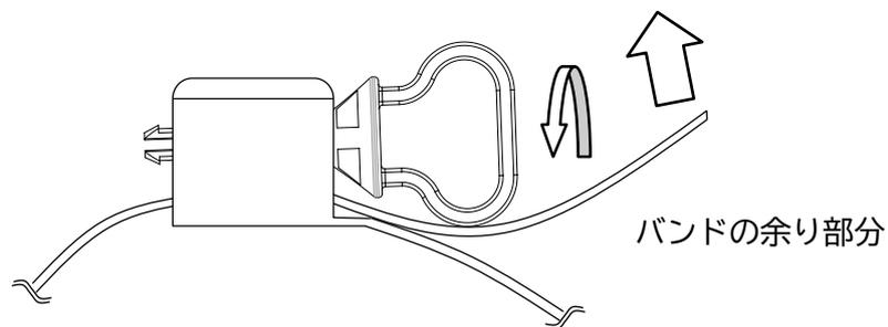
樹脂バンドの余り部分を矢印の方向に押し上げ、樹脂ボルトが斜めになった状態で回して取り外す。
