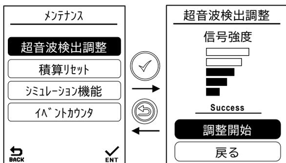
「開始」を選択すると、プログレスバーが表示され、バーレベルが4段階まで進むと調整完了となります。成功時は「Success」、失敗時は「△ No Echo」を表示します。
