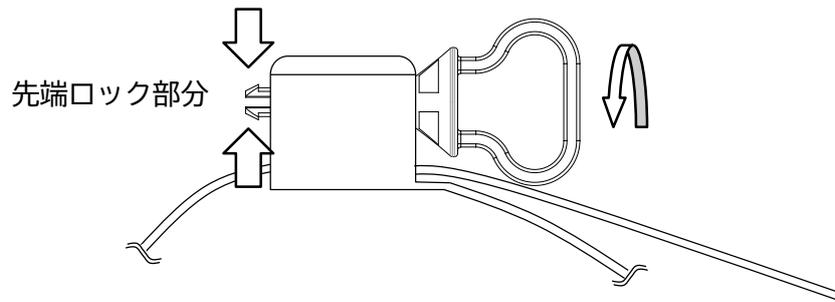
先端ロック部分をラジオペンチ等の工具で矢印の方向に挟みながら、樹脂ボルトを回して取り外す。
