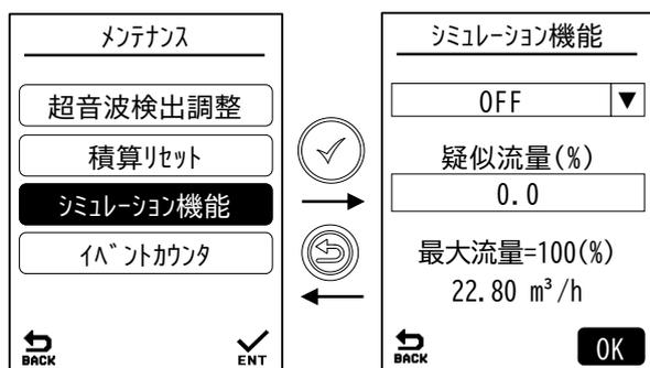
「OK」押下後に、積算値もカウントアップする警告が表示されます。「ENT」押下で実行、「BACK」で実行せずに戻ります。実行後、計測表示画面には「疑似流量(%)」の計測値と、「SIMULATED FLOW」が表示されます。
