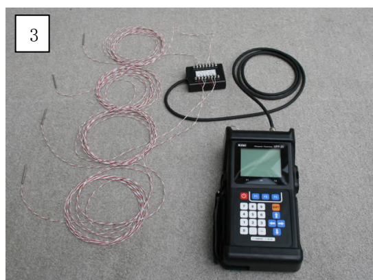
3. 測温抵抗体及び本体側の接続完了
