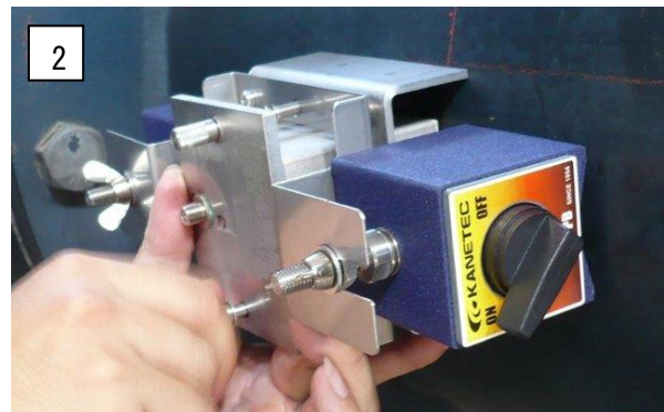
2. センサのネジを締めてカプラントを塗布した面と管を接触させます。
