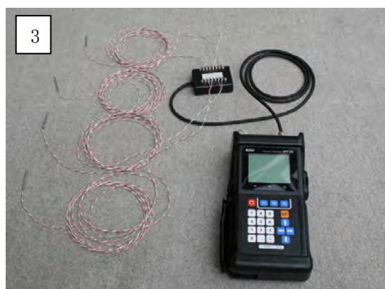
3. 測温抵抗体及び本体側の接続完了
