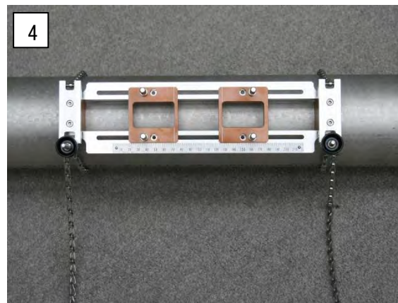
4. もう一方の端の鎖も同様に締めて、両端で管に固定します。
