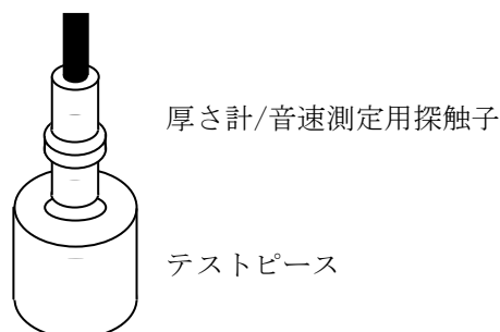
図 2.2.7-3 厚さ計/音速測定用探触子の校正
