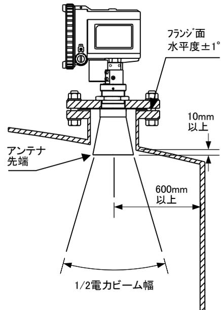
図 2.1.1 コーンアンテナ取り付け例
