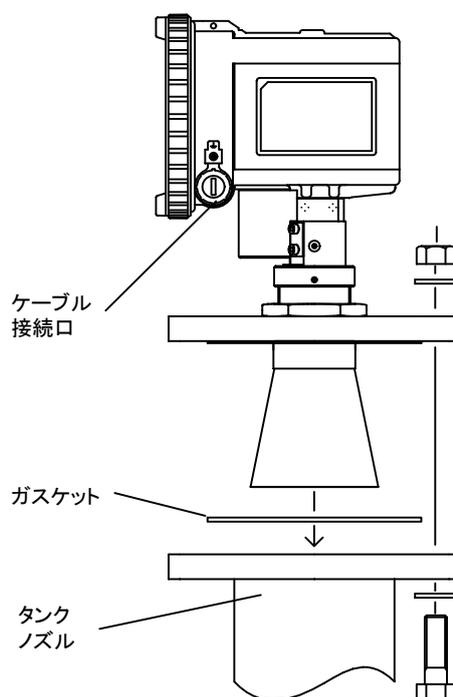
図 2.3.4 電波レベル計 レベルショット MRG-10の取り付け
