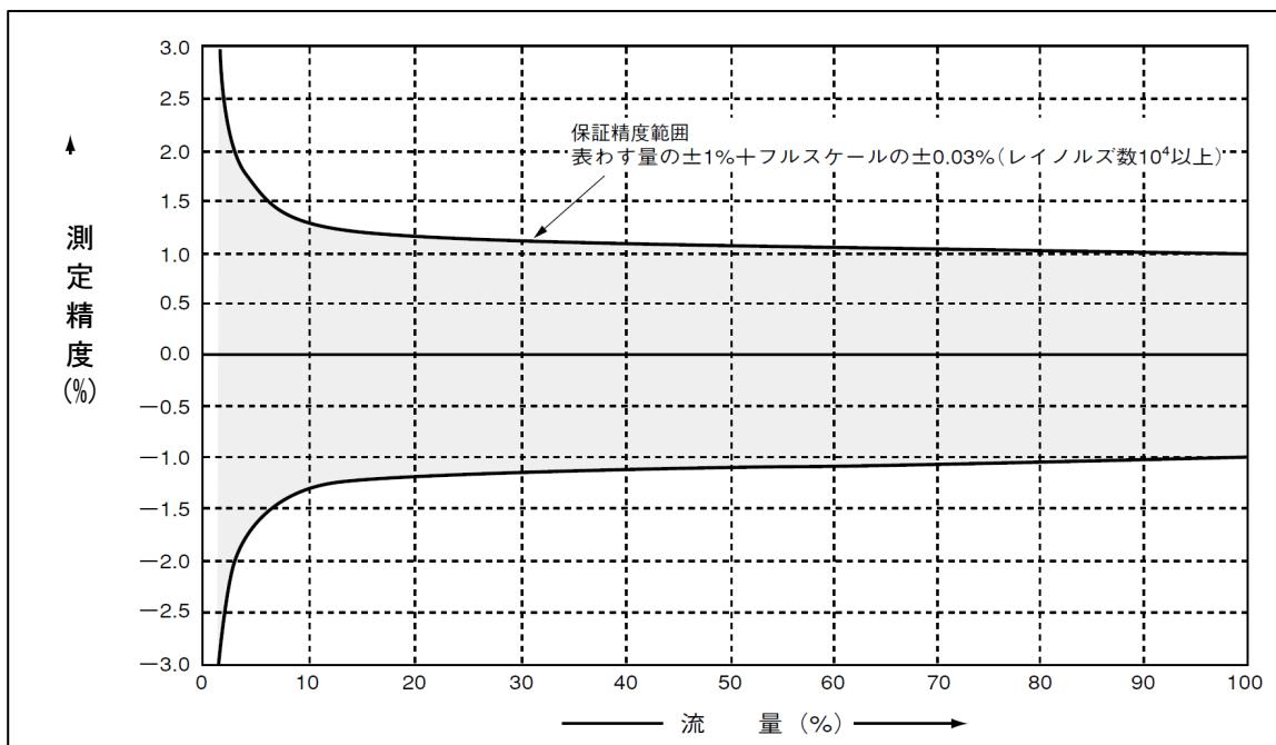
注）流量(%)軸の100%が流量範囲表（表9-2）の最大流量（換算流速で±30m/s）に相当します。
