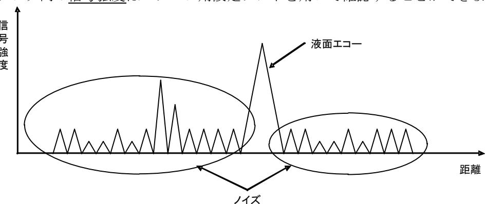
図 5.3.1 タンク内の信号強度
