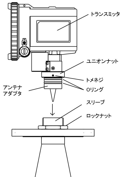
図 2.3.3 コーンアンテナの取り付け
