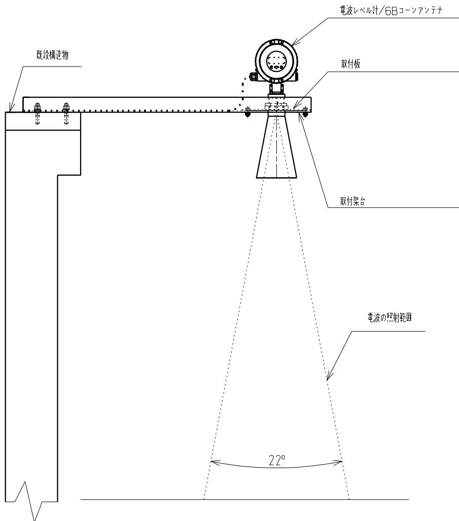
図 2.5.7 電波レベル計 レベルショット MRG-10の取り付け例
