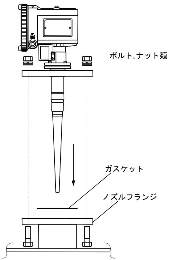
図 2.4.3 電波レベル計 レベルショット MRG-10の取り付け
