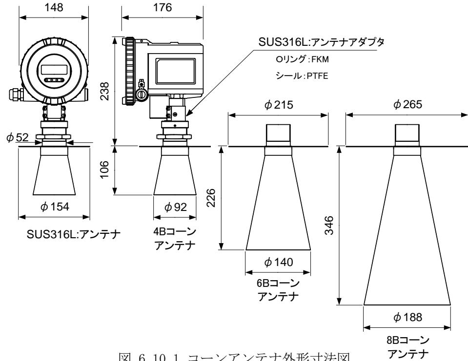
図 6.10.1 コーンアンテナ外形寸法図
