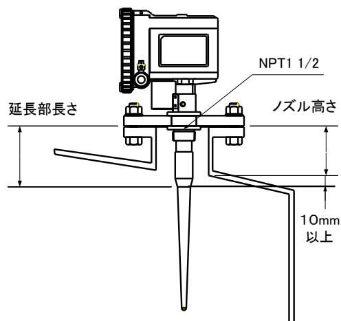
図 2.1.3 ロッドアンテナの取り付け例
