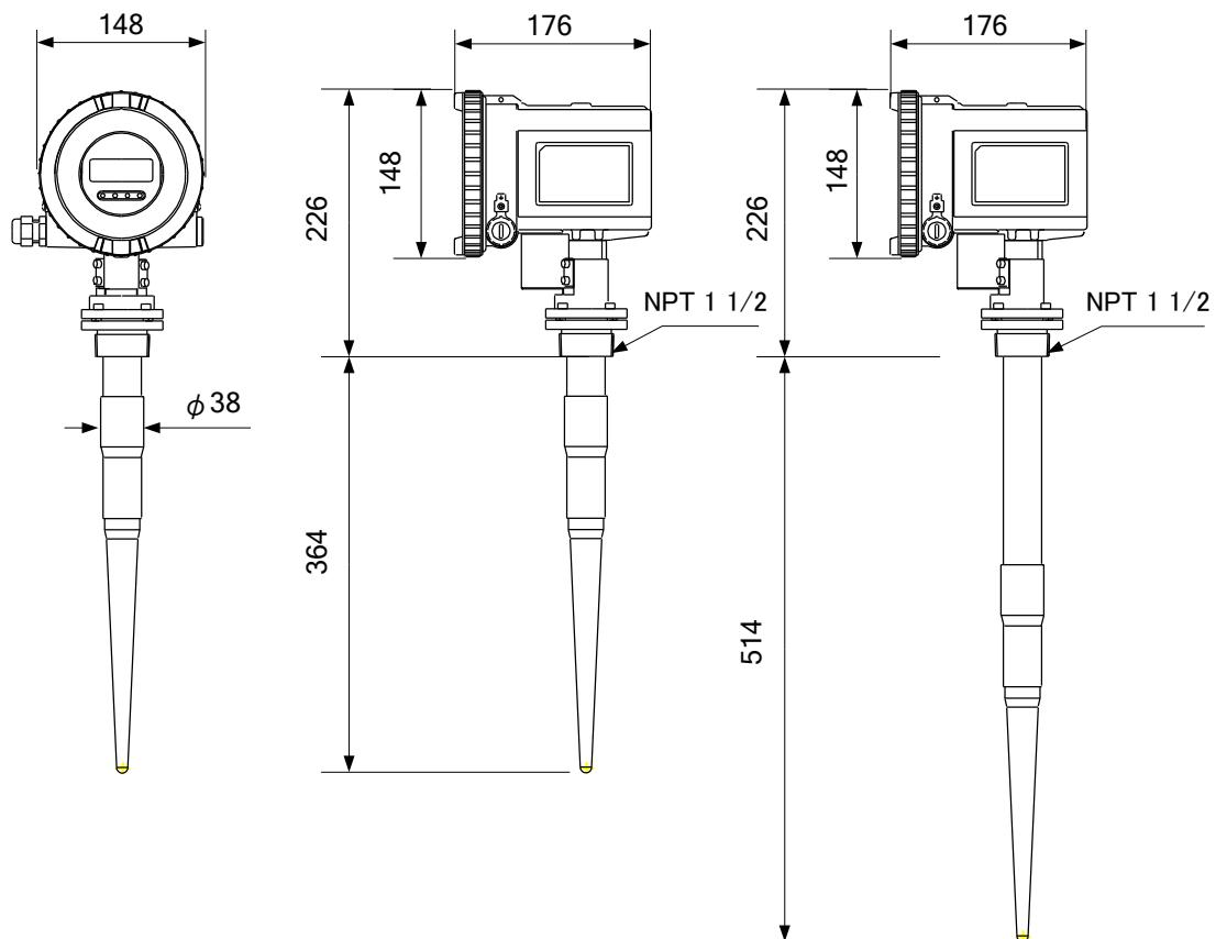
図 6.10.2 ロッドアンテナ外形寸法図
