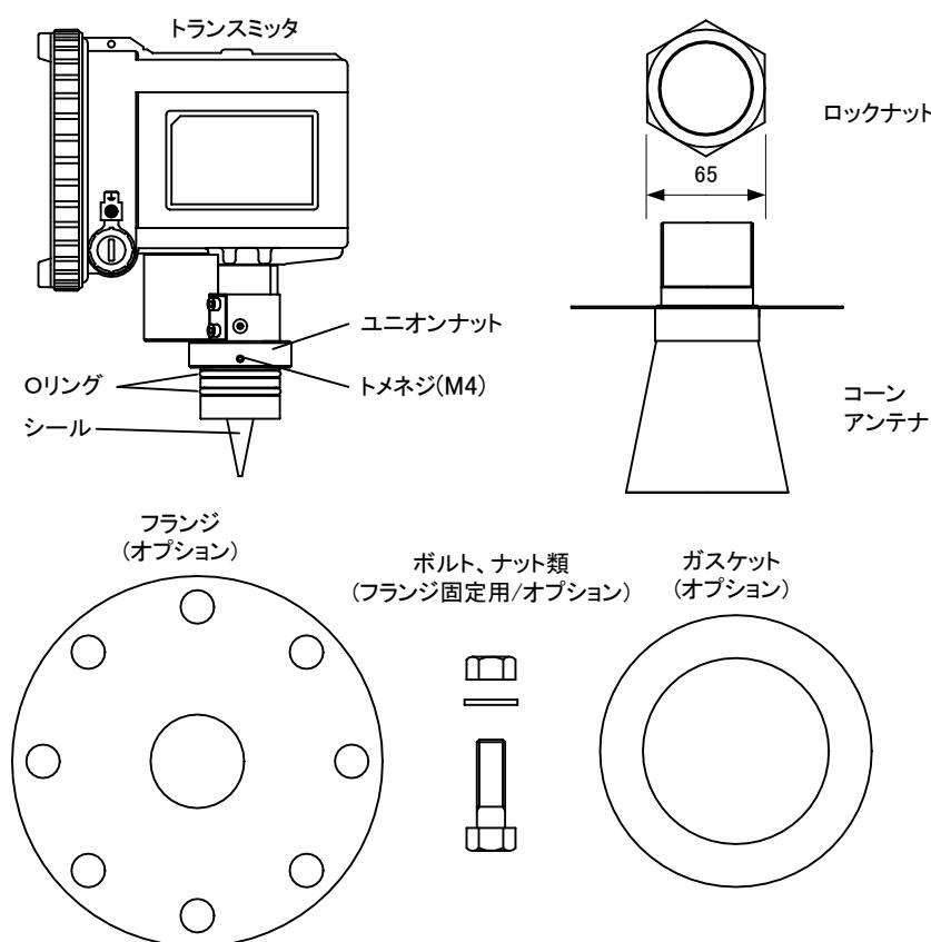
図 2.3.1 コーンアンテナの装備に必要な器具
