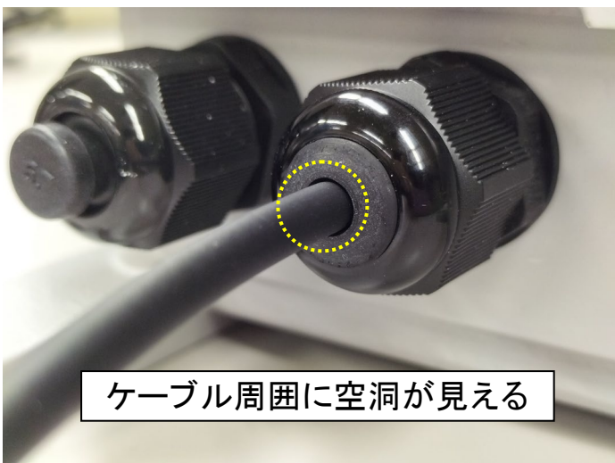
図 3 ×適正なトルクを超えて締めた場合
