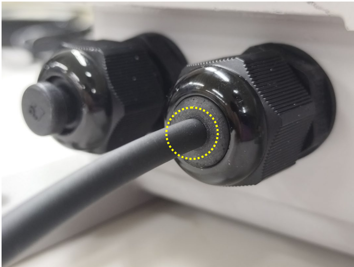
図 2 ○適正なトルクで締めた場合
