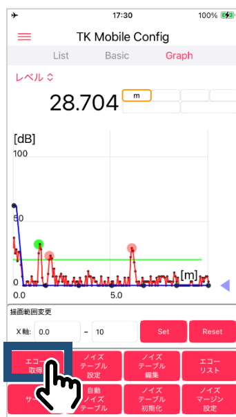
図 4.4.3.1 エコーカーブとノイズテーブルの表示(例)
