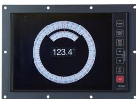
10.4インチのカラー液晶表示器に、ジャイロコンパス方位をアナログ表示します。
