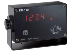
コンパス本体(マスターコンパス)から方位信号を受け取り、方位を0.1度単位でデジタル表示します。(例: 000.0~359.9)コンパクトなデザインで設置場所を選びません。ユニット形状は卓上型/壁掛型/埋込型の3種類を用意しています。オプションとして防水埋込型/防水壁掛型もあります。
