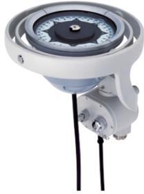
レピータコンパスを水平に保持します。主に操舵室内で使用されます。保持器はレピータコンパス・接続箱と組み合わせて使用します。接続箱にはレピータ用の照明スイッチとディマーが付属しています。
