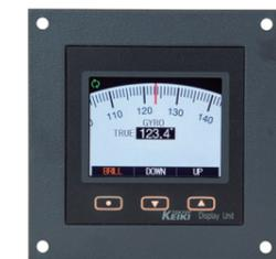
3.5インチのカラー液晶表示器に、ジャイロコンパス方位や磁気コンパス方位をアナログ表示します。
