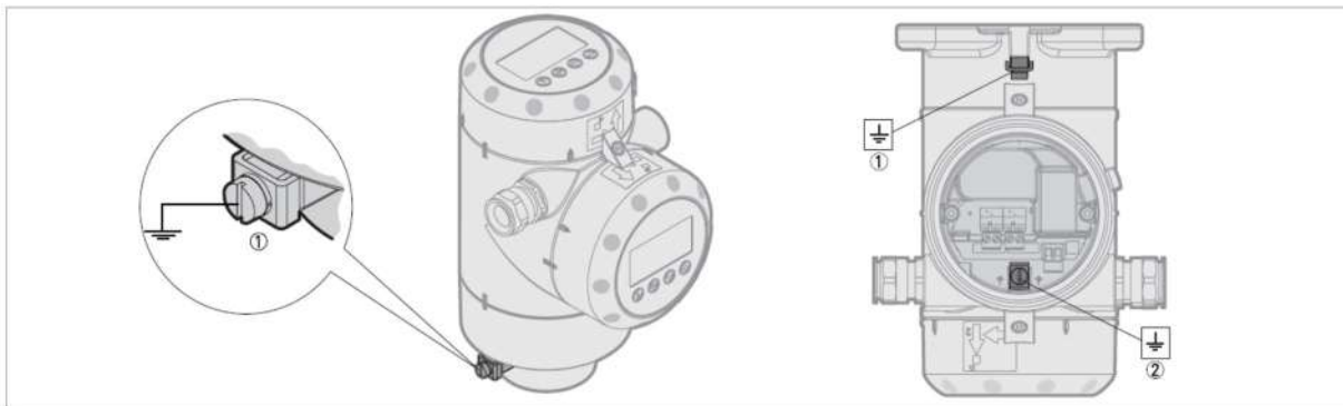
図 3-9 : 等電位接地システムの端子接続例
