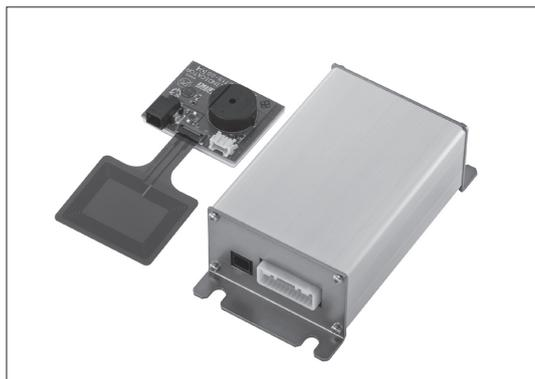
VMUシリーズは建設機械向けに開発された、RFIDリーダ・ライタです。車載ネットワーク（CAN）インターフェースやON/OFF入出力を備えており、建設機械のユーザー管理や盗難防止といった機能を提供します。
