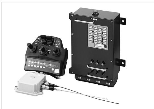
建設機械用の比例ラジオ・リモート・コントロール・システムです。パワーシヨベルをはじめ各種建設機械に搭載され、好評を博しています。比例用のジョイスティックが5本ありますので、ほとんどの建設機械に対応可能です。受信機の出力はRS422のシリアル通信信号です。油圧の電磁弁などを直接駆動することができる制御ユニットもオプションで用意してあります。使用電圧は特定小電力タイプですので、免許なしで、すぐに使うことができます。
