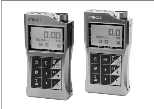
超音波厚さ計は、非破壊で対象の厚み測定を行う装置です。配管の腐食検査など、設備保全として用いられています。他の非破壊検査手法と比較し、簡便に検査が可能です。
