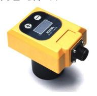
ボリュームキーパ VK-2412 は小型・高精度超音波センサにて合材供給量を監視し、最適な供給量を常に保つようにスクリューの回転数を制御する装置です。
