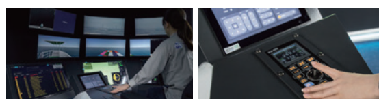
陸上側の非常対応ブロックに装備されたジョイスティックコントローラ。この小さなコントロールレバーを動かすだけでオートパイロットを操ることが可能
