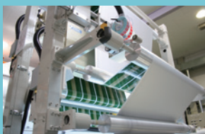
印刷ミスや異物混入を自動で高速に探知する印刷品質検査装置
