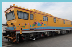
超音波でレール内部の傷を検知する超音波レール探傷車
