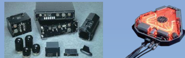
危険なレーダー照射などの警報を発する航空機用レーダー警戒装置 潜水艦などに搭載される高精度のリングレーザージャイロ
