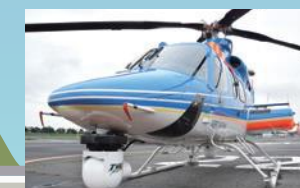
姿勢制御により安定した映像送信を実現する報道ヘリ用アンテナ自動指向装置
