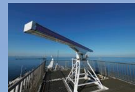
船舶通航管理システムに使用される海上監視レーダー
