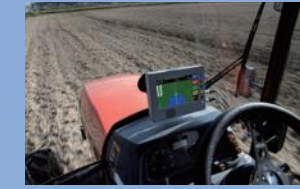
トラクターが自動で直進できる自動操舵補助装置
