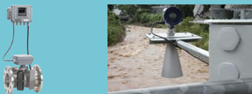
上水、農業用水、工業用水の管理に使われる超音波流量計 河川の水位上昇をいち早く知らせる危機管理型水位計
