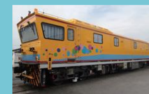
超音波でレール内部の傷を検知する超音波レール探傷車
