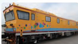
超音波でレール内部の傷を検知する超音波レール探傷車
