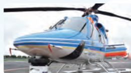
姿勢制御により安定した映像送信を実現する報道ヘリ用アンテナ自動指向装置
