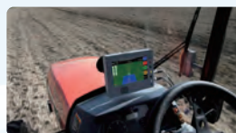
トラクターが自動で直進できる自動操舵補助装置
