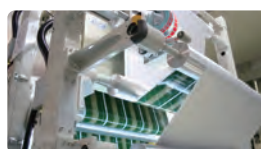
印刷ミスや異物混入を自動で高速に探知する印刷品質検査装置
