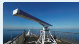
船舶通航管理システムに使用される海上監視レーダー
