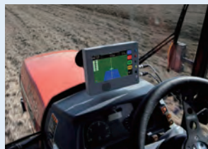
トラクターに装着する 直進自動操舵補助装置
