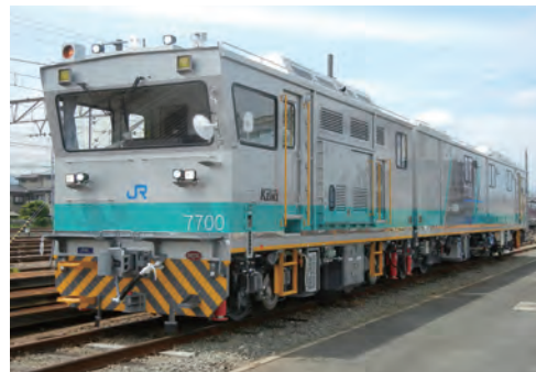
主力製品の超音波レール探傷車
