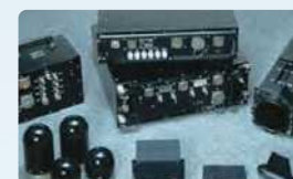
危険なレーダー照射などの 警報を発する 航空機用レーダー警戒装置
