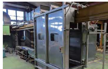
自社設計・製作の洗浄装置でジクロロメタン削減
