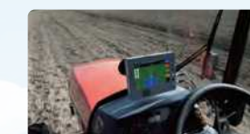
トラクターが自動で 直進できる自動操舵補助装置
