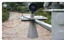
河川の水位上昇を いち早く知らせる 危機管理型水位計
