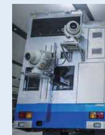
中継車用防振カメラ
