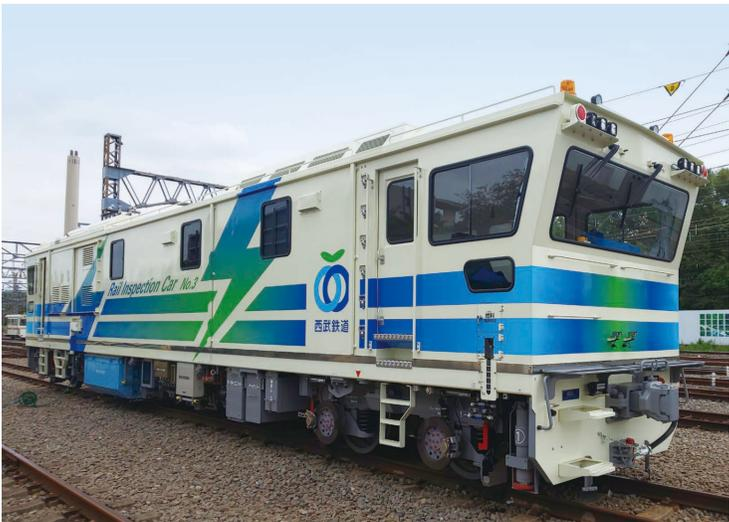
画像式超音波レール探傷器
