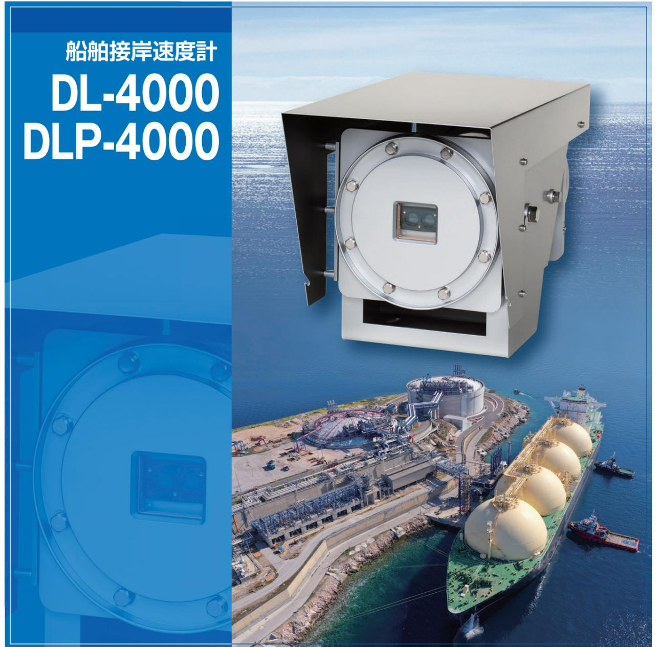
DL-4000/DLP-4000は、レーザ測距方式を採用した船舶接岸速度計です。大型船舶を安全に接岸するには、巨大な船体による慣性を制御し接岸スピードを適切にコントロールする必要があります。船舶接岸速度計は、船首、船尾それぞれの接岸距離を計測し接岸速度、角度を算出します。計測・算出したデータをリアルタイムに表示することによって安全な接岸を支援します。また、レーザ距離計は栈橋上に設置されますので、接岸する船の大きさや潮位にあわせて最適な場所にセットすることができます。ポータブル型のDLP-4000は、バッテリー駆動で小型、軽量、持ち運び可能なため、設置・撤去が容易に出来ることから定置型接岸速度計DL-4000のバックアップや仮設用途で活躍します。
