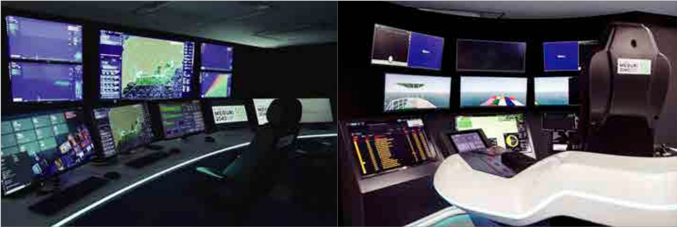
FOCの統合表示ブロック。無人運航船の運航状況や周囲を航行中の他船情報、気象海象情報など航海に必要な情報が統合表示され、状況に変化があった際には音声や表示によって陸上オペレーターに通知する。 FOCに設置された非常対応ブロック。幾つもの大型モニターを配し、航行中の無人運航船の状況がリアルタイムで確認できる。本船の周囲を360°映し出す3Dパードビューのモニターによって、本船や他船、周辺の状況、避航ルートなどが直感的に把握できるのも特長だ。緊急時にはここから本船を遠隔操作する。
