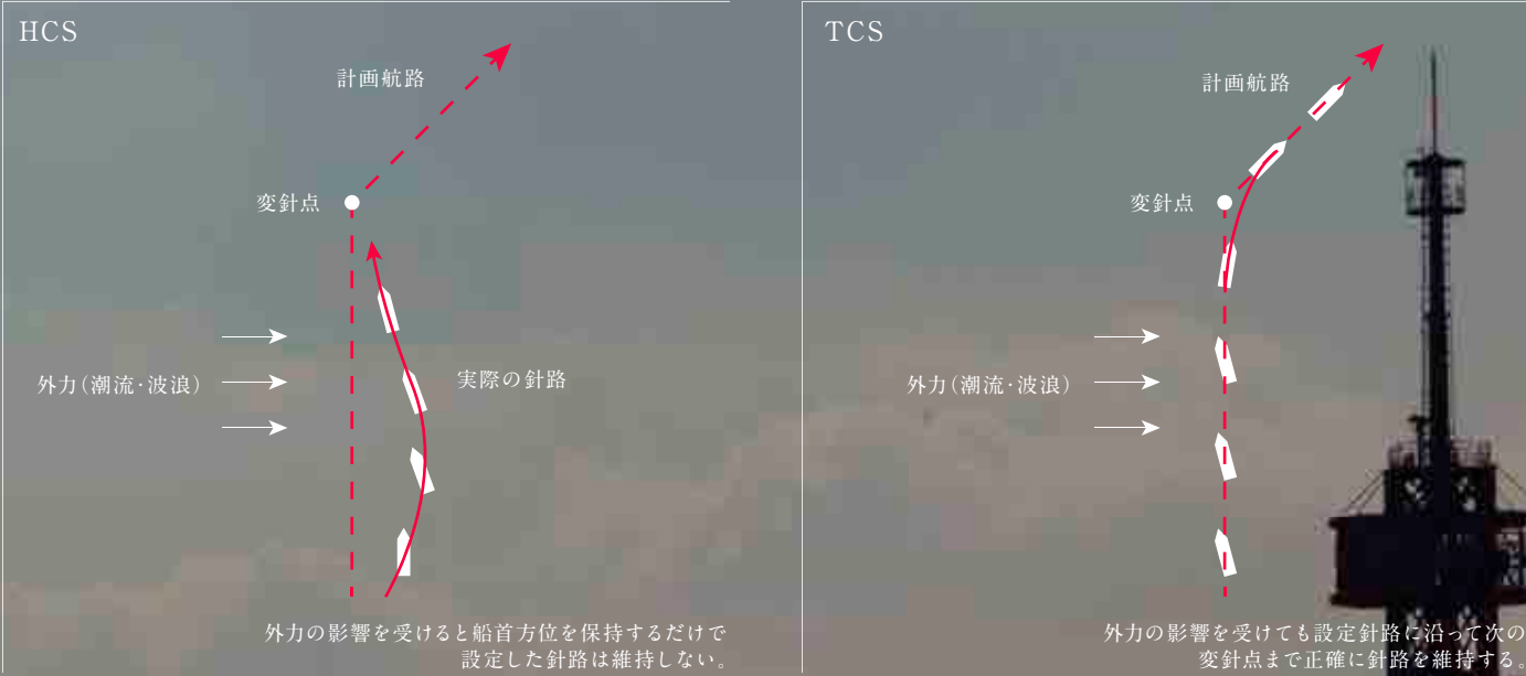
図1 一般的な自動操舵(HCS)とトラックコントロール(TCS)の違い
