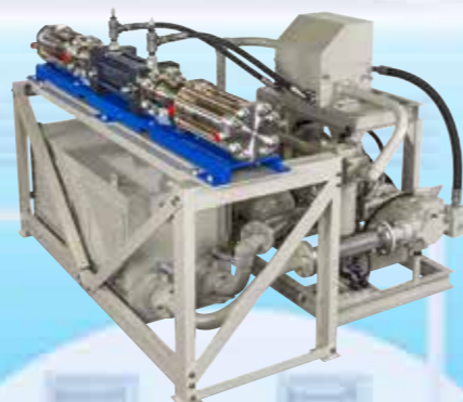
トラックに搭載されているTPSの油圧ユニット
