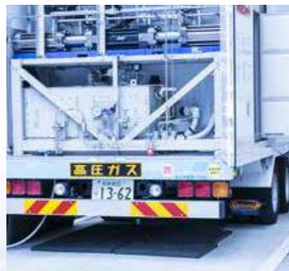
トラックに搭載されているTPSの油圧ユニット
