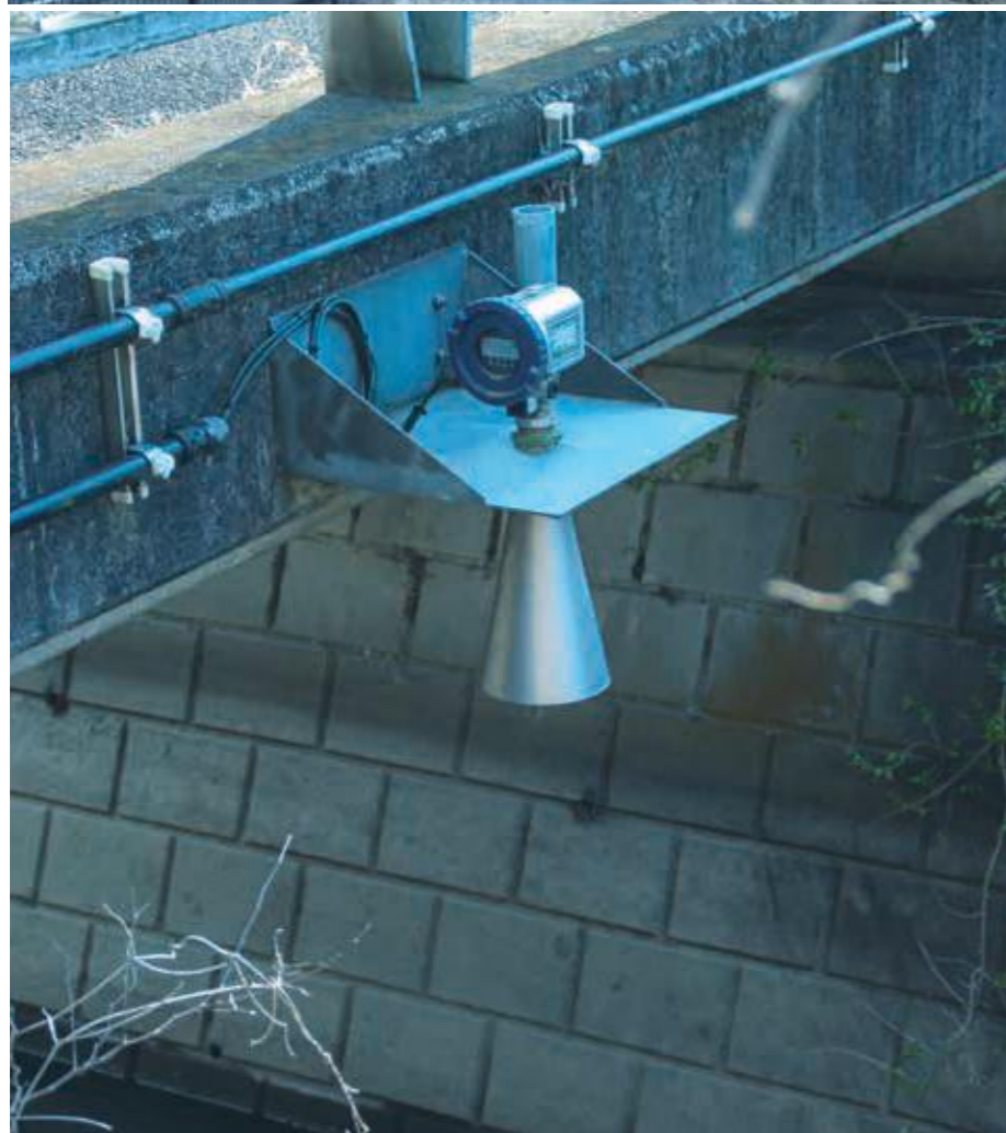
電波レベル計MRG-10 マイクロ波を使って非接触で水位を計測できる最新のレベル計です。UF-960と組み合わせた流量計システムのコンポーネントの他、河川の水位監視用としてもご採用いただいています。
