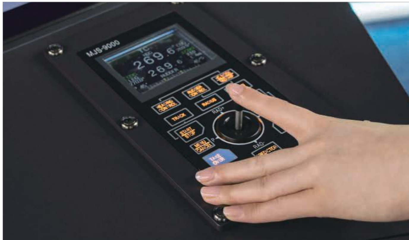
非常対応ブロックに装備された東京計器のジョイスティックコントローラMJS-9000。この小さなコントロールレバーを動かすだけで無人運航船を自在に操ることができる。
