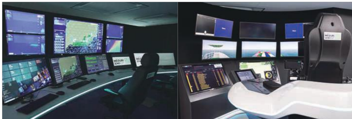
FOCの統合表示ブロック。無人運航船の運航状況や周囲を航行中の他船情報、気象海象情報など航海に必要な情報が統合表示され、状況に変化があった際には音声や表示によって陸上オペレーターに通知する。
