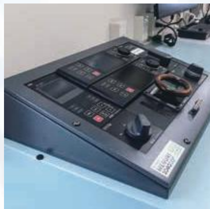
DFFASコンテナに搭載されたオートパイロットPR-9000。DFFAS用として再構成した特別仕様となっている。
