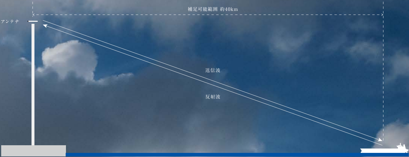
VTSレーダーが船舶を捉える仕組み
