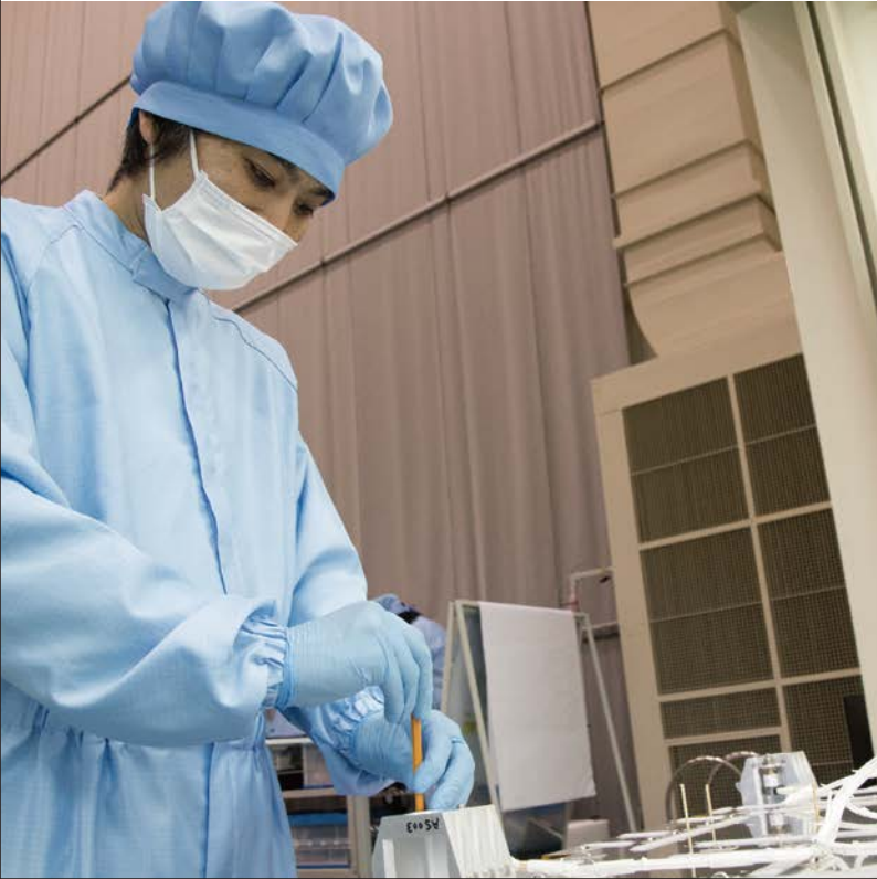
■ 構体パネルの組み立て 構体はいわば衛星のボディで、衛星の箱型構造を構成し、搭載機器の支持や内部の機器を保護する役目も果たす。
