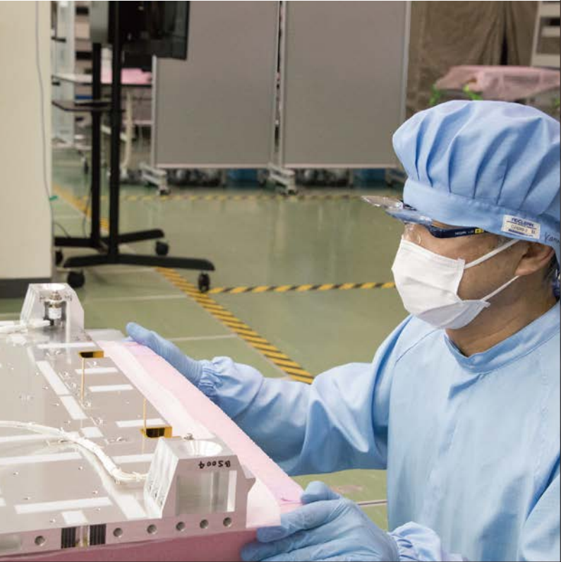
■ 部品の組み立て ここで組み立てられた部品は構体（こうたい）と呼ばれるパネルに搭載される。
