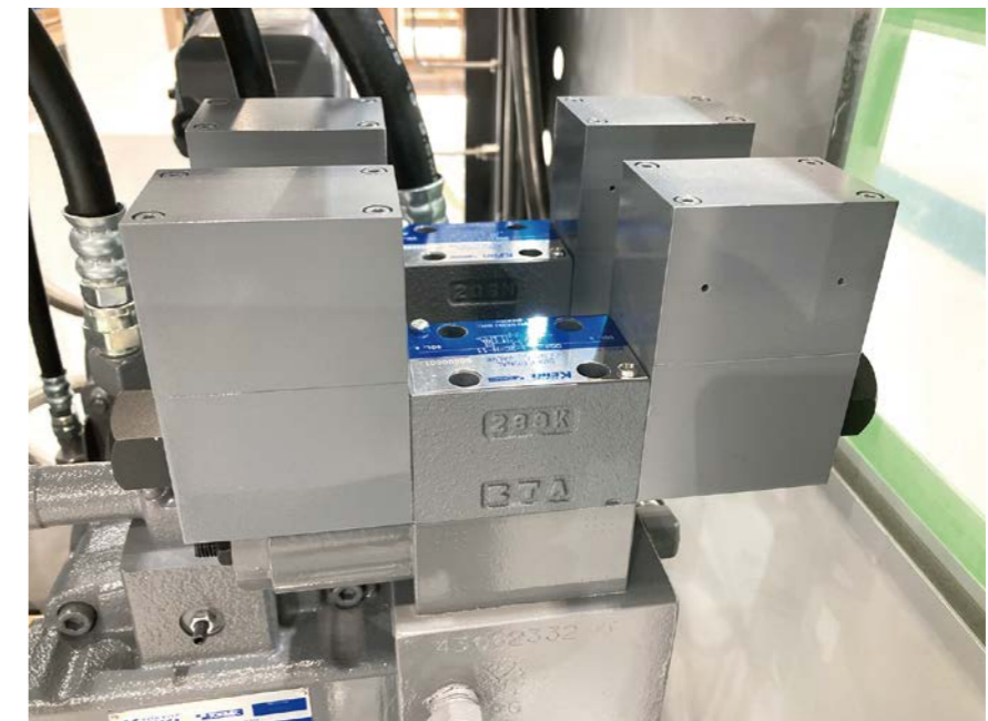
水素ステーションは防爆エリアとなるため、防爆認定されていない電磁比例制御弁などは使用できません。小型水素圧縮装置には東京計器の新製品「耐圧防爆電磁切換弁DG4VX」が装備され安全性を高めています。
