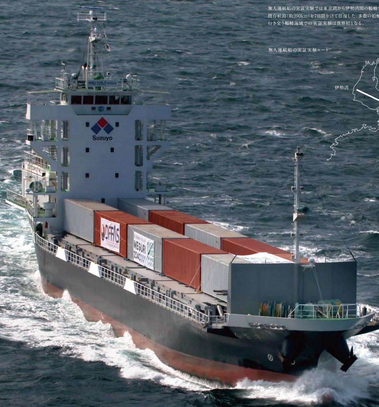
DFFASの無人運航システムを搭載した「すざく」ですが、現時点での法律では乗組員ゼロの航海は認められないため、通常の航海と同様に5名の乗組員が乗船して実証実験が行われました。しかし、乗組員は離着岸作業以外では操船作業には関わらないため、実質的な無人運航と言えます。よりリアルな航海を再現するためカーゴスペースには10台のコンテナを積載するなど実運用に近い状態で実証実験が行われました。日本有数の輻輳海域として知られる東京湾の浦賀水道では、他船の状況を判断して避航操船を行うなどハイレベルな無人運航が可能なることを実証しました。「すざく」は計画通り東京湾と伊勢湾を往復し、3月1日の午前6時38分に、大井水産物埠頭に着岸して実証実験を終えました。ここで得た貴重なデータは、今後の無人運航船の研究開発に大きく役立てられます。東京計器のオートパイロットPR-9000と光ファイバージャイロコンパスTF-1000はこのたびの実証試験において高い性能を発揮し、輻輳海域でも無人運航船を安全な航路に導くと共に、実証実験の成功に大きく貢献しました。
