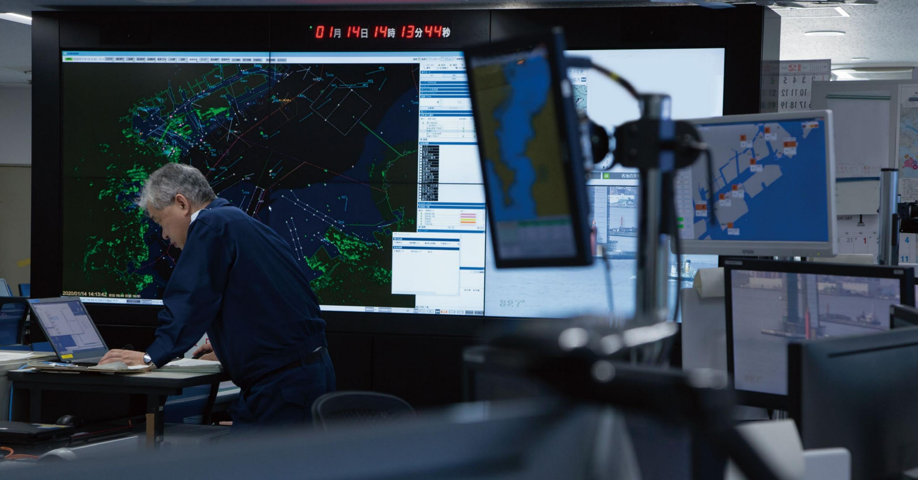
VTSに用いられるレーダー運用装置のディスプレイには東京湾内に設置されたレーダーの映像とAIS(Automatic Identification System: 船舶自動識別装置)から得た船舶情報を合成した船舶の位置情報が表示されます。船舶動静データ解析処理装置や管制支援データ収集処理装置などから得た情報を合わせて表示することも可能です。船舶動静データ解析処理装置は、今までに収集・蓄積した船舶の航跡パターンを解析することで最適な航跡モデルデータを抽出し、目的地への到達予測時間や危険を生じる可能性がある海域エリアを特定したり、予想される船舶同士の見合い関係(両船の位置)を表示したりします。管制支援データ収集処理装置は、速度超過や航路を外れるなど不適切な航行をする船舶を点滅表示で知らせたりするものです。
