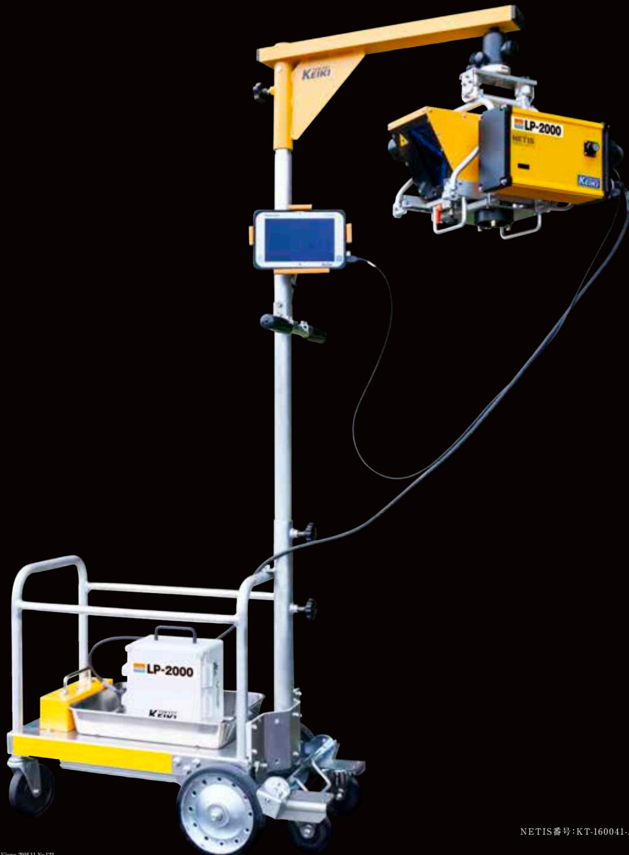
アスファルトで舗装された道路は、大型車や乗用車の往来が繰り返されるうちに重さで沈み込み、やがて「わだち掘れ」ができてしまうのは避けられません。特に近年の夏のような猛暑が続くとアスファルトが熱で変形してしまい、傷みも大きくなります。こうして傷んだ道路を補修する際には、事前に路面の横断形状(わだちの凸凹)を計測し、補修に必要なアスファルトなどのボリューム計算などを行うことが必要です。
