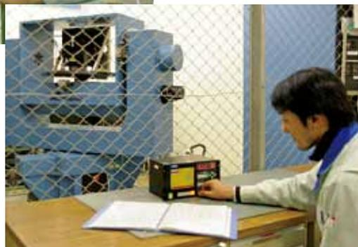
ジャイロセンサ部の検査は、3軸レートテーブルと呼ばれるテストスタンドで実施される。ここでは方位角、ピッチ角、ロール角の計測精度をテストする。
