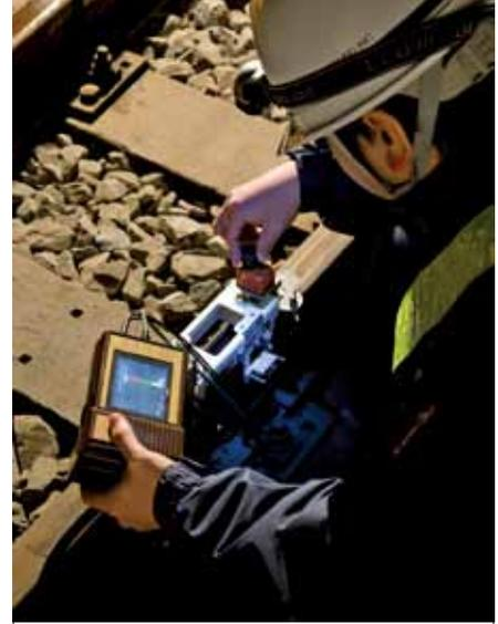
レール内部に発生した傷と SM-3Rでの探傷画像の例
