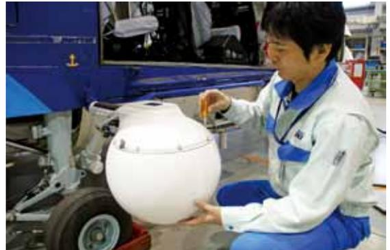
■アンテナ自動指向装置のパラボラアンテナ
