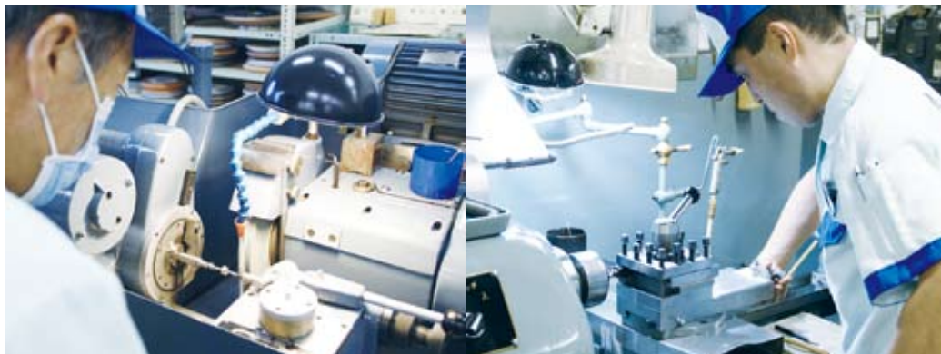
円筒研削盤や汎用旋盤を使用する超精密加工
