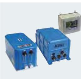
3軸の光ファイバジャイロおよび加速度計を用いて方位角・ピッチ角・ロール角をリアルタイムで表示する、慣性航法装置の技術を応用した高精度ジャイロコンパスです。長距離／カーブ工事の施工精度向上に貢献します。
